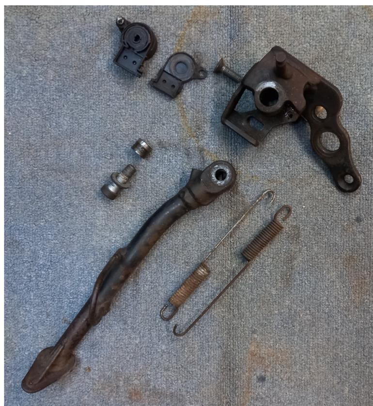
Si les petites clips de fixation des deux moitiés du boîtier plastique sont cassés , le boîtier qui contient le micro switch peut s'ouvrir , ces clips sont très fragiles après 20 ans...
