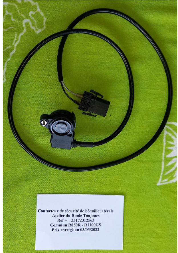
L'ingénieur qui a conçu ces pièces , dans son infinie sagacité a prévu que la prise soit environ 1 mm trop grosse pour passer facilement dans le trou du support gauche de béquille latérale. On peut essayer de forcer mais vu le prix de l'ensemble , on hésite à casser la prise. On peut aussi essayer de démonter le boîtier du micro-switch car le micro-switch , lui passe facilement , mais là aussi on risque de casser le boîtier.
